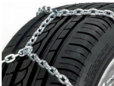
4.40 Для движения по скользкой дороге на покрышки надевают цепи (рис.4.40).
