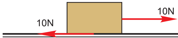
a) Sükunət sürtünmə qüvvəsi cismin hərəkətinə mane olur
