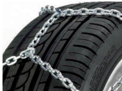
4.40 sürüşkən yollarda avtomobilin şininə zəncir bağlayırlar
