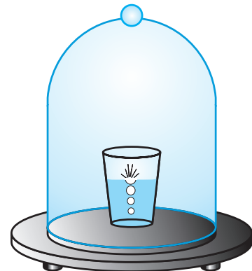
სურ. 3.39 ვაკუუმში წყალი დუღს ოთახის ტემპერატურაზე
